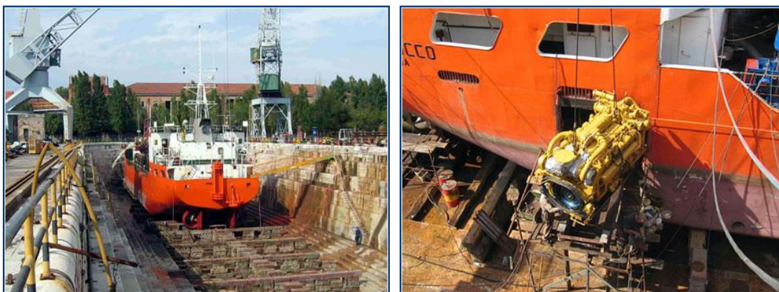
La M/N in bacino per modifiche e sostituzione motori
